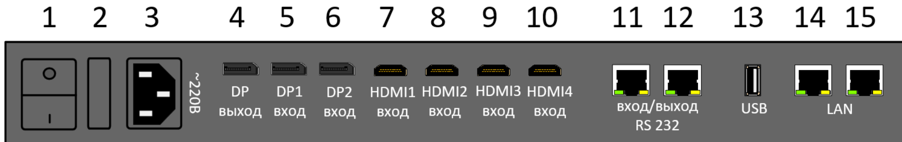
Рисунок 12. Вид со стороны интерфейсов Панели.
