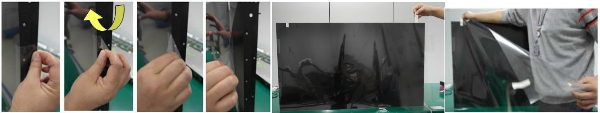
Рисунок 11. Снятие защитной пленки с Панели.
