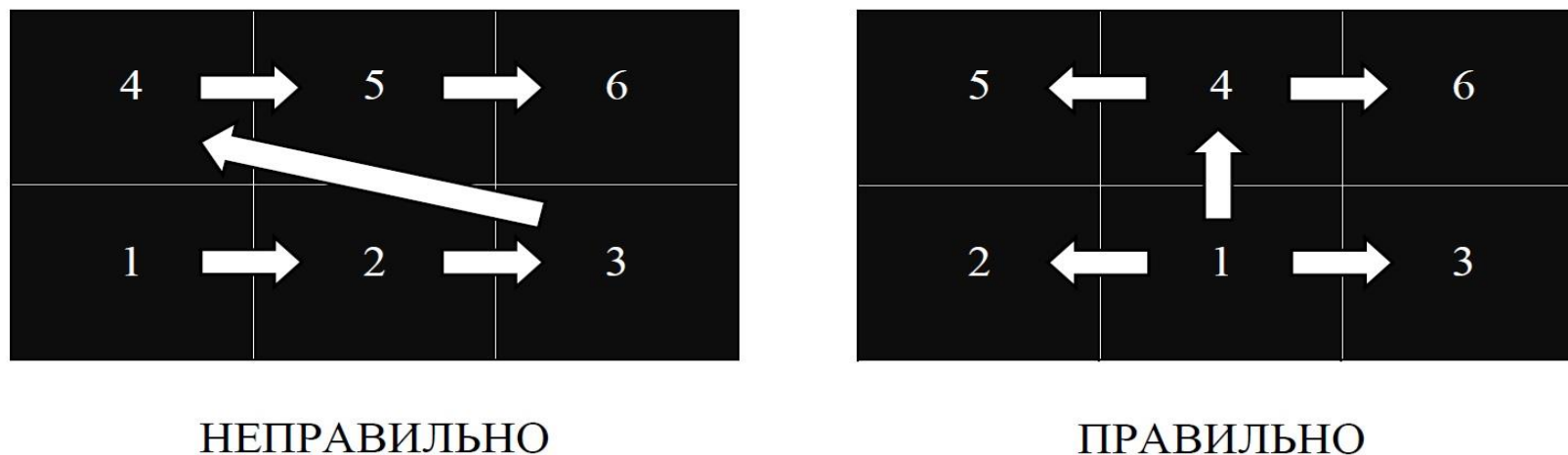
Рисунок 6. Очередность монтажа Панелей при сборке видеостены.
